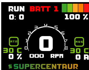
一號電池異常
